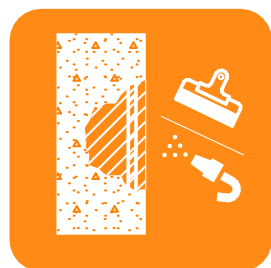
заделка дефектной зоны
