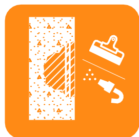
заделка дефектной зоны
